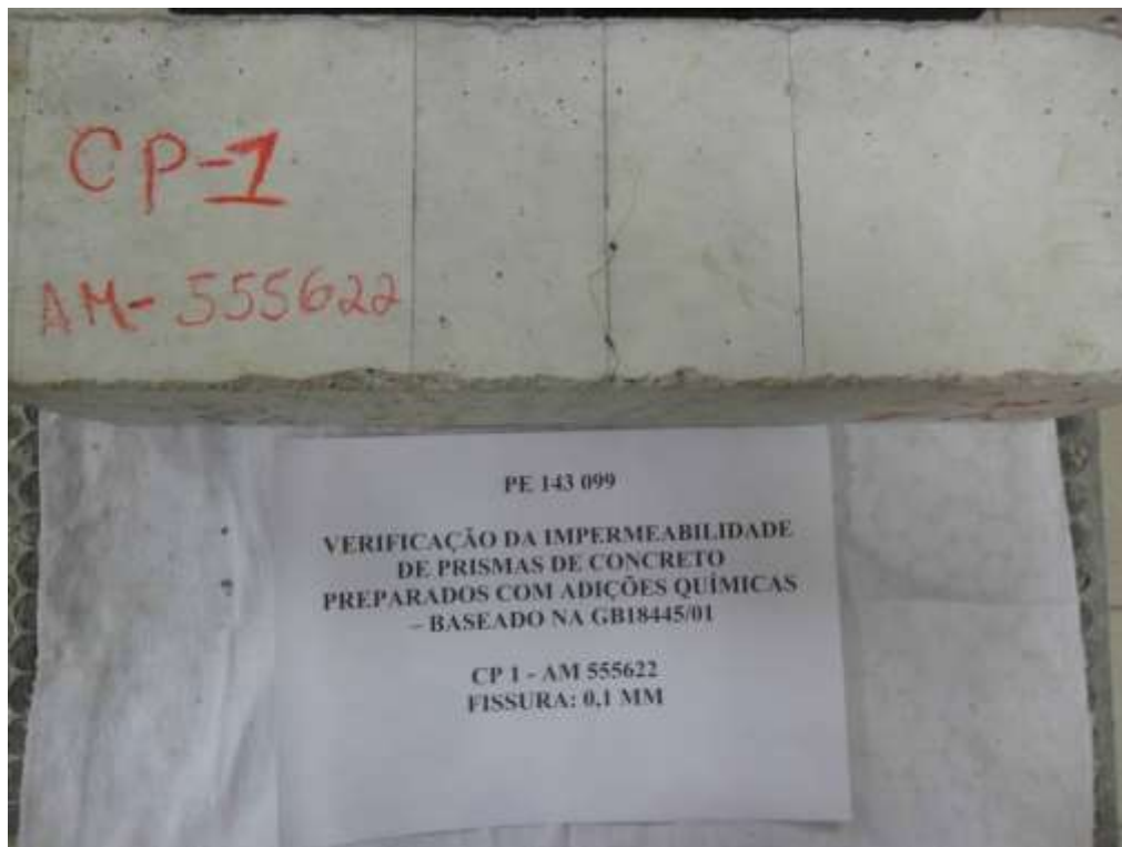
CP 1 Muestra 555622 – Fisura 0,1 mm
