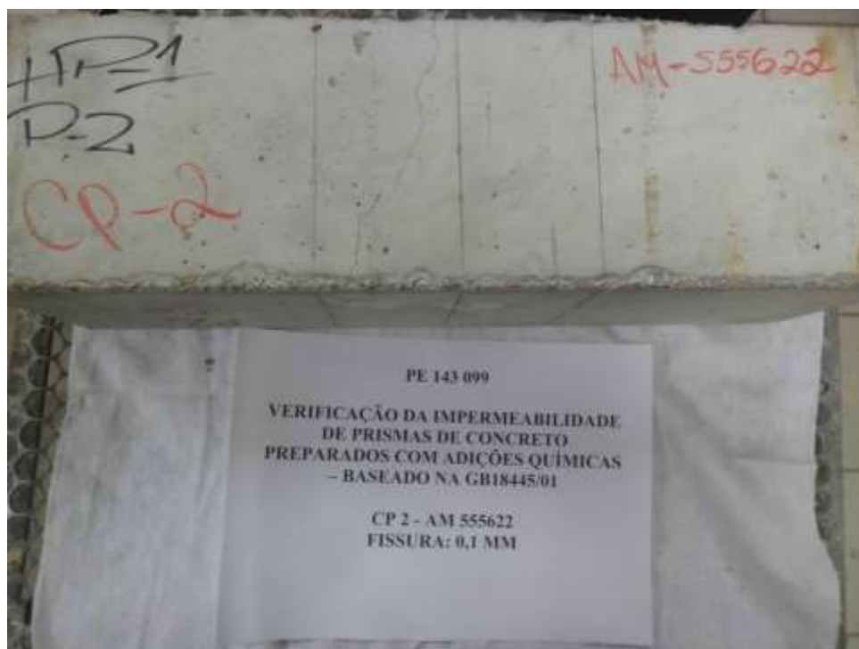
CP 2 Muestra 555622 – Fisura 0,1 mm
